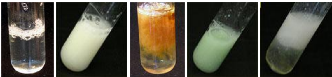
Obrázek 38: bílek ve vodě, po zahřátí, po přidání extraktu z duběnek, roztoku \text{CuSO}_4 , ethanolu
