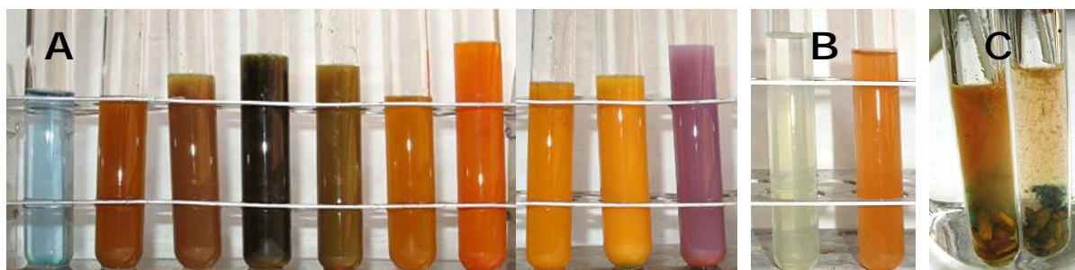
Obrázek 27: A – Fehlingův test: oslazená voda, med, rozinky, hroznové víno, jablko, mandarinka, citron, banán, cibule, mléko (červený oxid měďný se usazuje na dně), B – syrovátka vzniklá vysrážením kaseinu z mléka a důkaz laktosu v syrovátce, C – intenzivnější červené zbarvení při Fehlingově testu na zralých jablkách než u nezralých jablek
