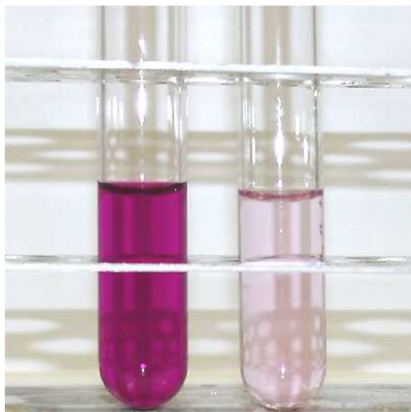
důkaz formaldehydu v hydrolyzátu z pryskyřice, vpravo: výluh zastudena – pouze stopy formaldehydu
