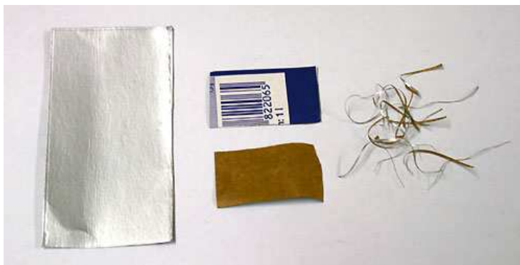
hliníková folie oddělená z papírové vrstvy nápojového obalu, rozstříhané hliníkové proužky
