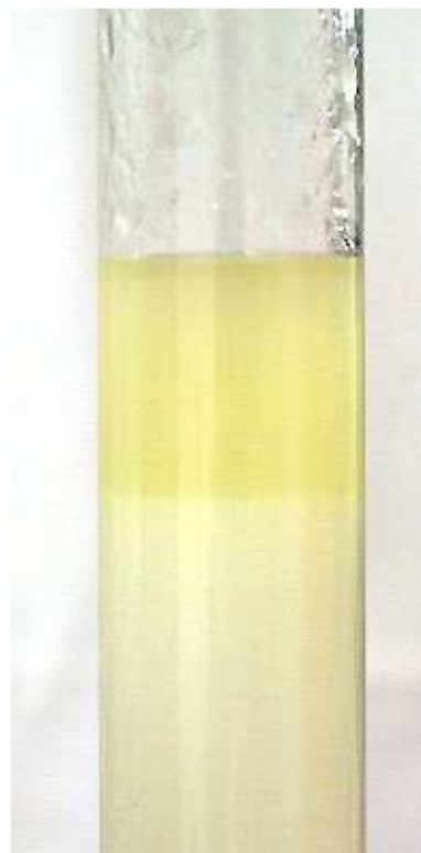
čirá reakční směs v kádince – vpravo rozvrstvení produktů: horní vrstva je bionafta
